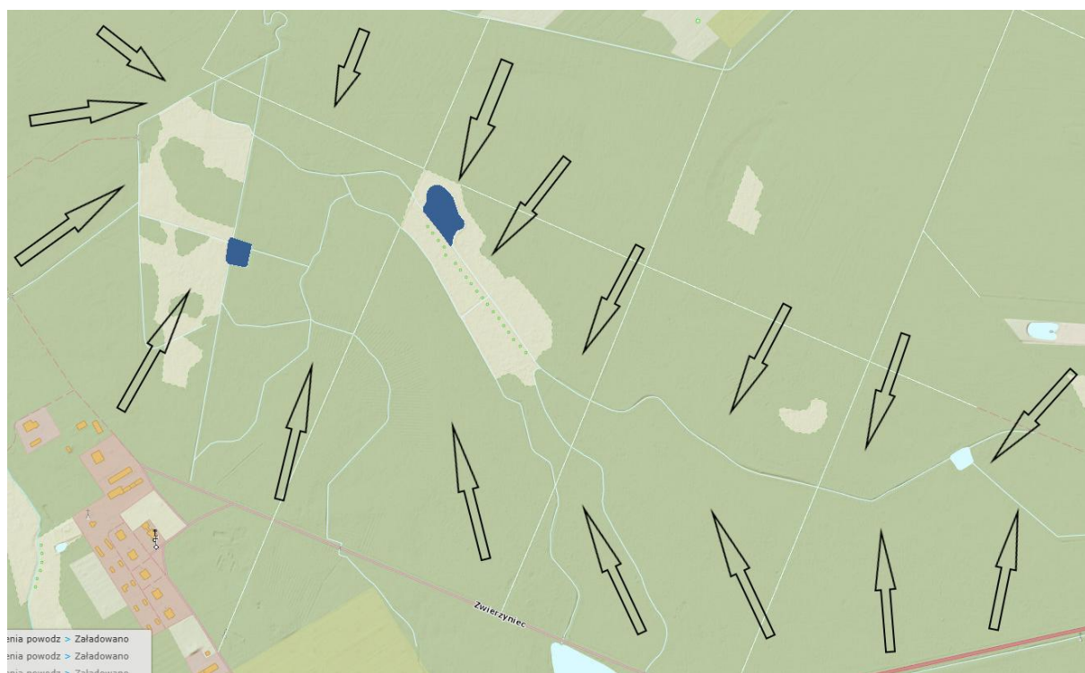
Rys. 2. Spadki terenowe i kierunki spływu wód powierzchniowych i gruntowych [źródło: https://wody.isok.gov.pl/ ]
